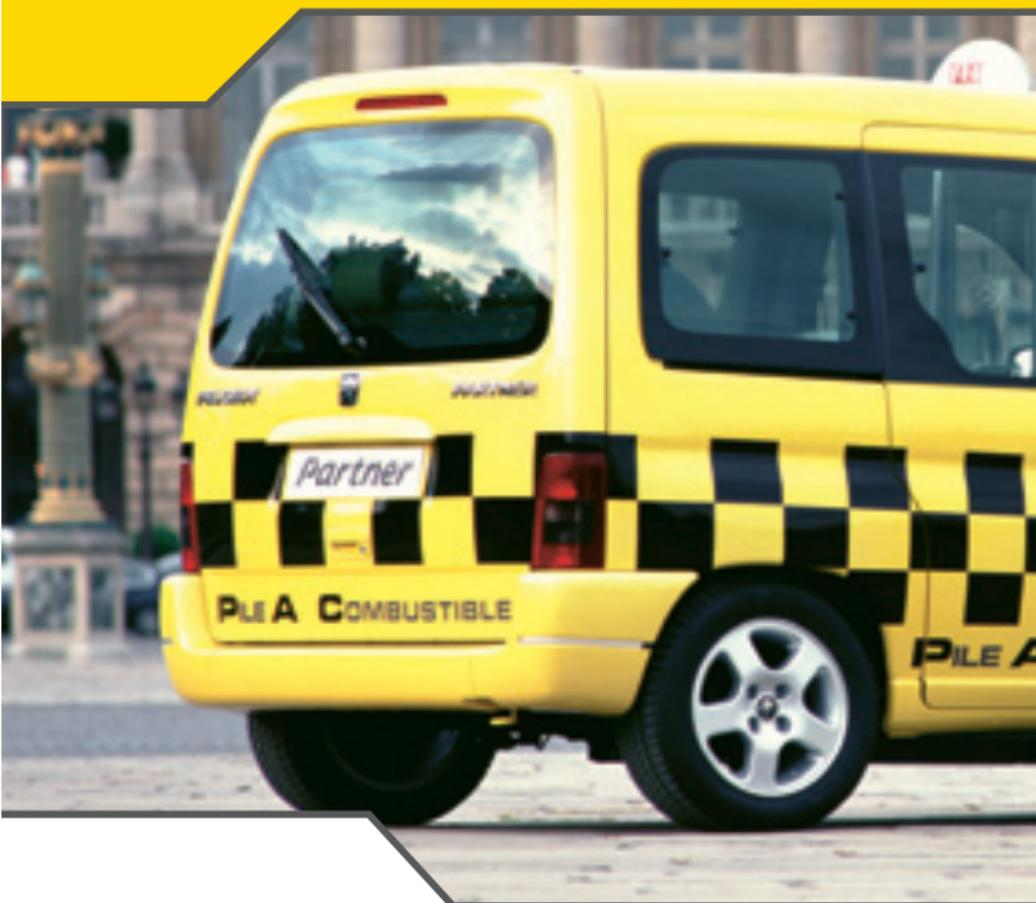
Le Groupe PSA PEUGEOT CITROËN a réalisé un démonstrateur sur la base d'un Peugeot Partner électrique. Sorte de **"taxi londonien du XXI<sup>e</sup> siècle"**, il conserve son moteur électrique d'origine (d'une puissance nominale de 22 kW) et **reçoit une pile à combustible de petite dimension** (5,5 kW), des batteries Nickel-Métal Hydrure ainsi qu'un "rack" amovible constitué de bouteilles d'hydrogène.
