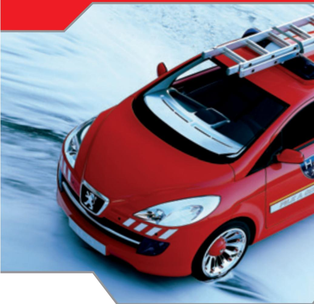
Le **démonstrateur H<sub>2</sub>O** est un véhicule électrique à batteries muni d'un générateur électrique constitué d'une pile à combustible (5,5 kW).
