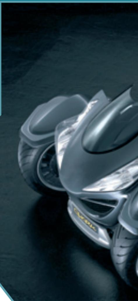
Dans la lignée de ses deux prédécesseurs, **le Quark** est un démonstrateur technologique utilisant une pile à combustible comme Range Extender. Ce véhicule à 2 places et 4 roues, totalement propre, est un symbole de liberté et se veut tout à la fois un engin futuriste, ludique mais aussi crédible par son contenu technologique.
